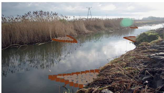
Ryc. 2. Propozycja umiejscowienia deflektorów drewniano-kamiennych na Wełnie w Rogoźnie (fot. K. Szoszkiewicz)
