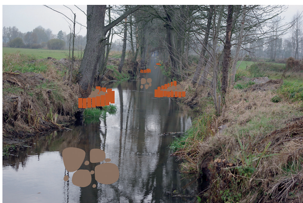
Ryc. 4. Usytuowanie proponowanych deflektorów drewniano-kamiennych i sztucznych wysp kamiennych na materacach faszynowych (fot. K. Szoszkiewicz)
